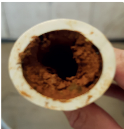
شکل ۴. تجمع بیوفیلم و مواد آلی در خط آبخوری
