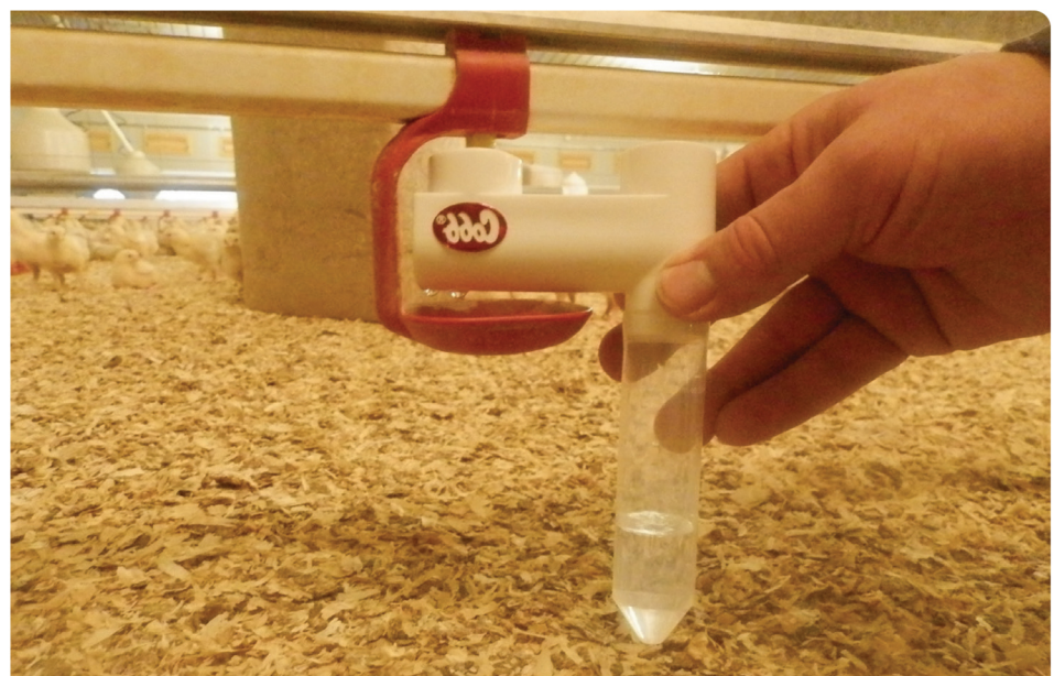
شکل ۲. محل قرارگیری دستگاه سنجش سرعت آب در نیپل
